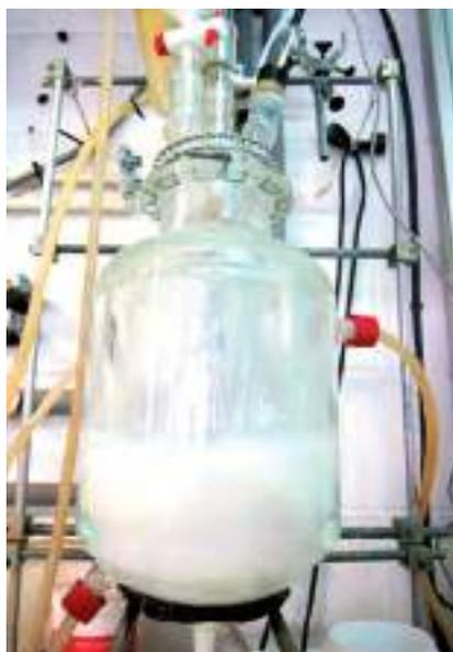
Reactor para fabricación de dispersiones
