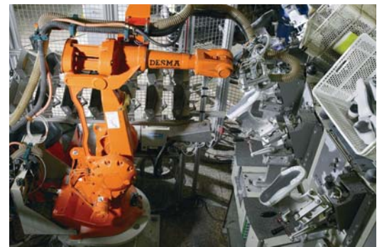
Robot de plantillas y cardado de la planta de producción
