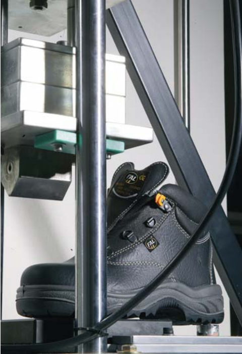
Máquina de prueba de resistencia al impacto, de los laboratorios de Fal Calzados de Seguridad, S.A.
