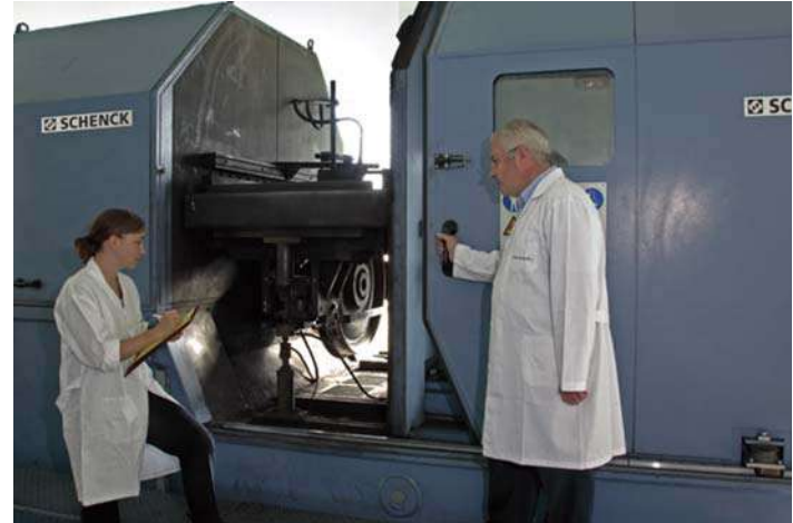
Dinamómetro utilizado por Icer Brakes para aplicaciones ferroviarias (escala 1/1)
