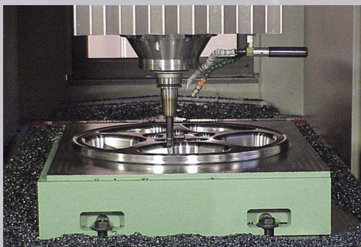
Mecanizado de molde de llanta de automóvil (pieza de demostración)
