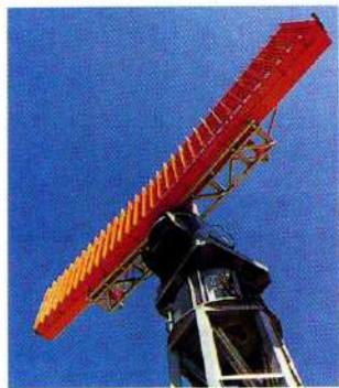
Antena de radar secundario en pruebas.
