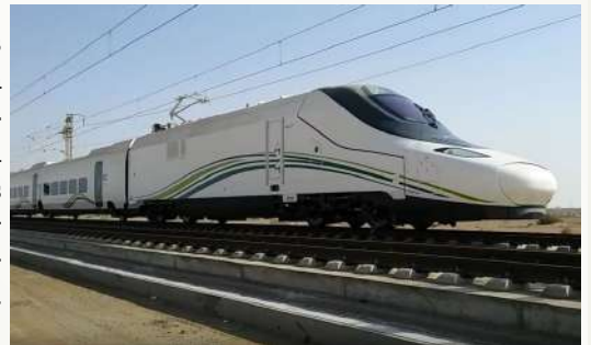
El diseño y la fabricación del Talgo 350 para el proyecto de Haramain requirieron el desarrollo de muchas patentes, entre ellas, la garantía de protección contra la arena y el polvo, la comodidad y seguridad de los pasajeros en climas extremos y formas de reducir el desgaste de las ruedas y los rieles en el desierto. Fuente: Página web Railway Technology.
