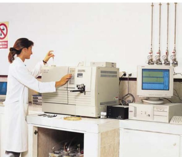
Laboratorio de análisis cromatográfico. Cromatógrafo GC-MS
