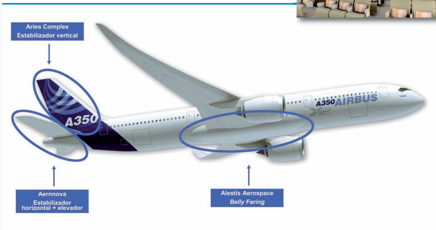
Distribución de los componentes adjudicados a empresas españolas en la fabricación del A350XWB (Ilustración: Airbus)
