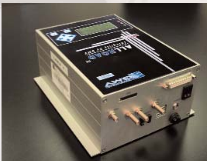
Unidad embarcada GNSS para peaje automático de GMV
