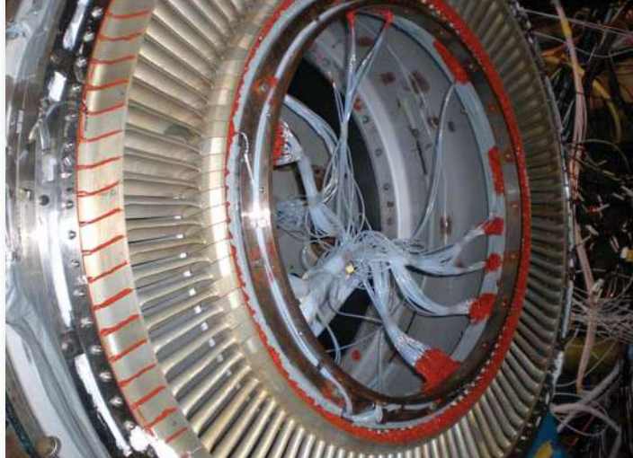
Fila de turbina totalmente instrumentada. Diseñada por ITP para ser ensayada en el programa VITAL. Fuente: ITP.
