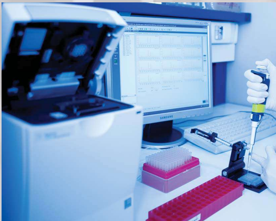
Control de calidad del RNA que se empleará en un experimento de DNACHIP.
