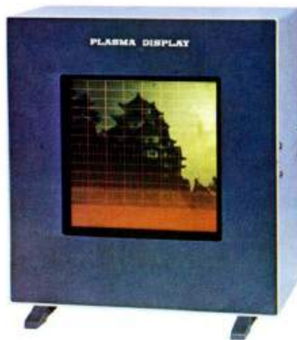
Display gráfico de plasma de alta resolución (512 x 512 líneas).
