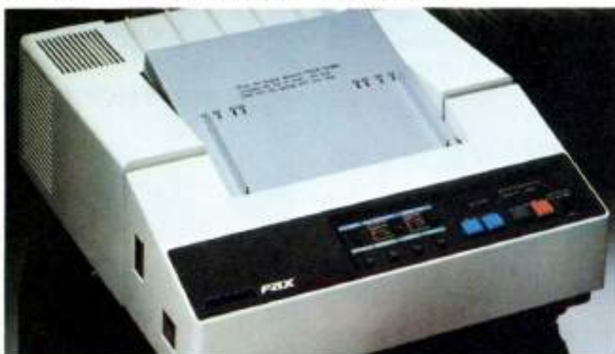
Transceptor facsimil utilizado en el Servicio Burafax.
