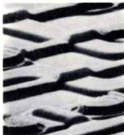
Imagen obtenida con microscopio de exploración electrónica, de un decodificador VITERBI. Muestra la estructura de cristal de Fósforo refundido cubriendo interconexiones de Polisilicio-Molibdeno y puertas de transistores de 2 \times 6\mu\text{m} .
