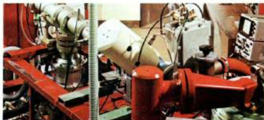
Sistema de implantación iónica, esencial para la fabricación de semiconductores.
