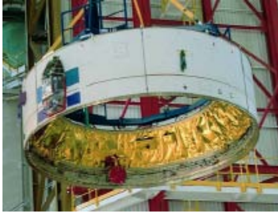
Fig. 14 Estructura en fibra de carbono de ARIANE 5 14
