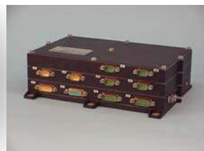
ROSETTA / Mars Express - Electrónica de la Cámara de Navegación y del Seguidor de Estrellas
