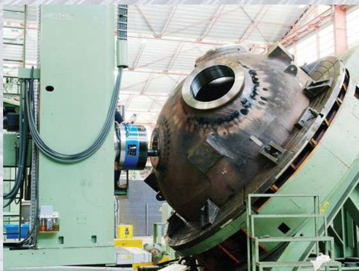
Mecanizado final en un fondo de generador de vapor
