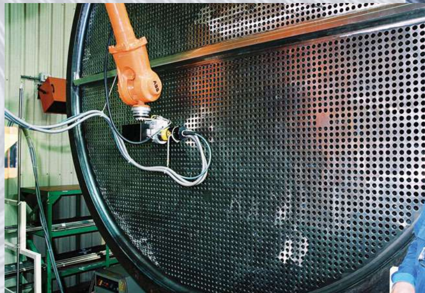
Marcado con láser de identificación de placa tubo por medio de robot
