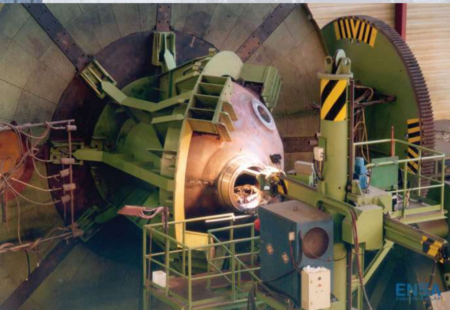
Plaqueado automático en tobera de fondo de generador de vapor
