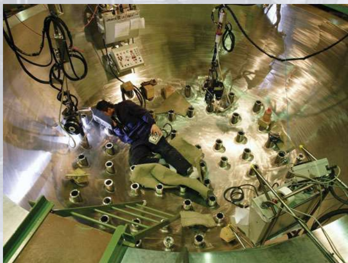
Soldadura automática de CRDM´s a tapa de la vasija - Proyecto CDTI
