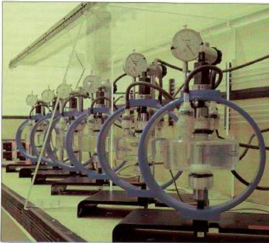
Equipo para el comportamiento de materiales SCC
