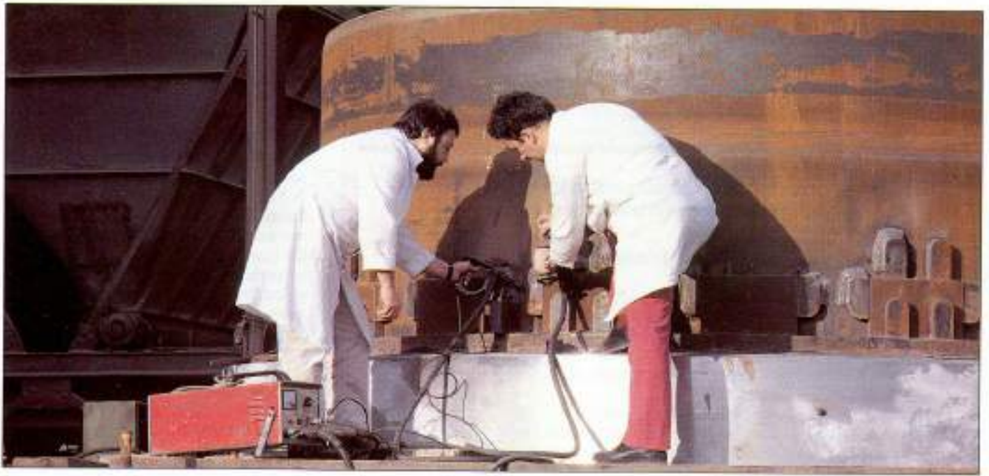
Proceso de verificación mediante ultrasonidos de una pieza fundida
