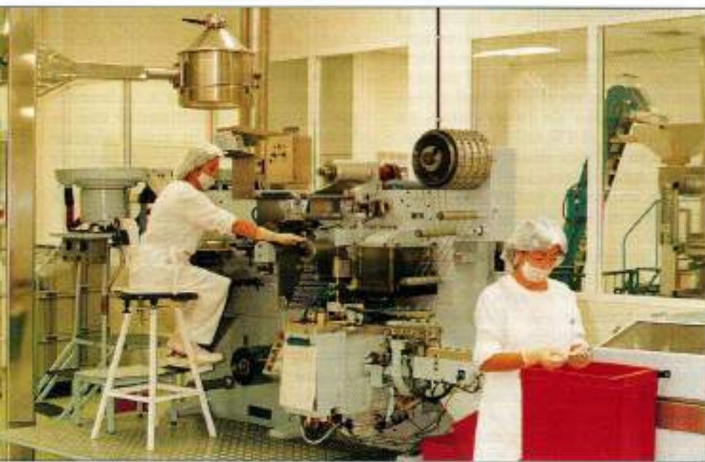
En esta sección de la planta de Martorelles se efectúa la producción de «blister»
