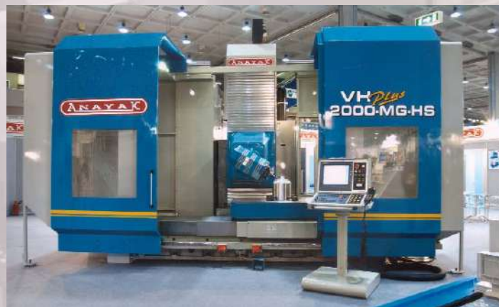
Máquina de nueva generación: centro de fresado de 5 ejes y alta velocidad
