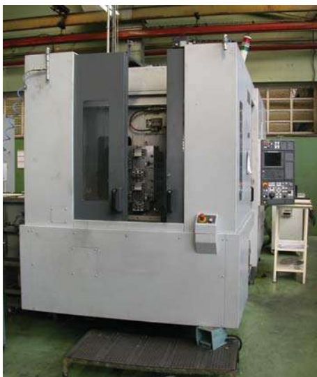
Centro de mecanizado para la fabricación de cilindros
