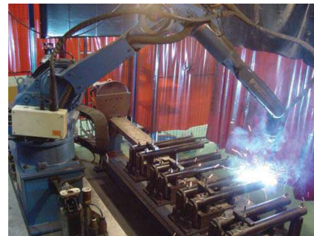
Robot de soldadura (método fabricación cilindros)
