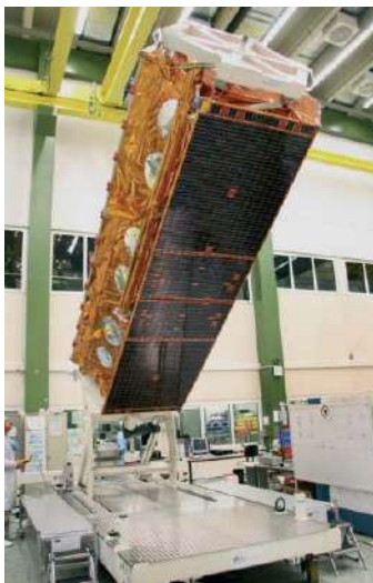
Imagen de Terrasar-X con su carga útil (Radar de Apertura Sintética). Para este tipo de tecnología se ha aprobado un proyecto en el PNE de esta convocatoria. © EADS ASTRIUM
