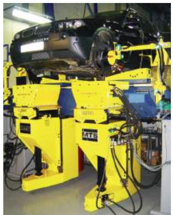
K&C: Ensayos de dinámica vehicular.
