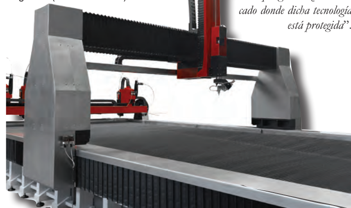
Instalación modular para corte de largas longitudes (sector ferroviario).
