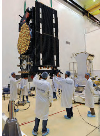
Uno de los satélites Galileo IOV con las antenas de navegación y de búsqueda y rescate, fabricadas ambas por empresas españolas. Fuente: ESA/CNES/Arianespace – Optique Vidéo CSG
