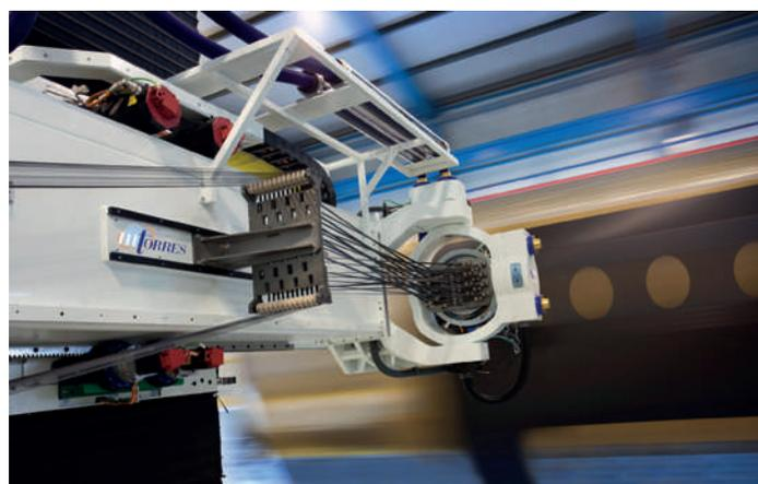
Fiberplacement para laminado de fibra de carbono
