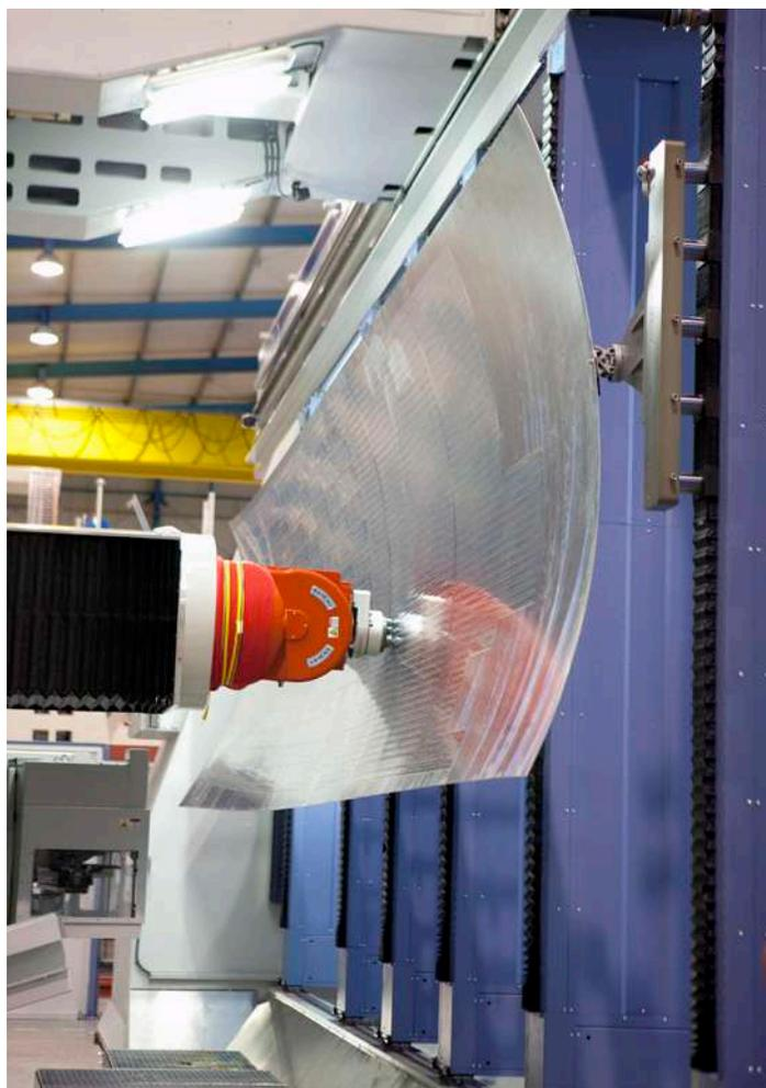
Fresadora para el mecanizado superficial
