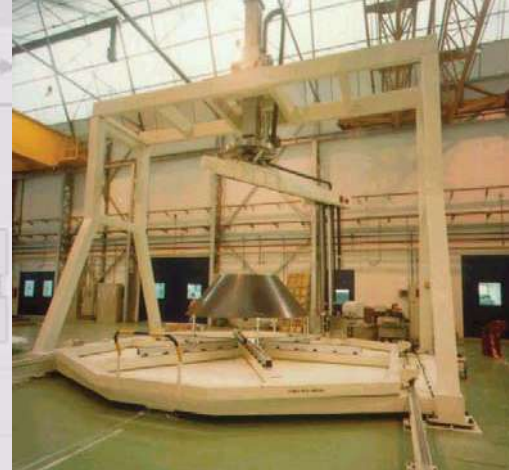
Sistema de inspección de cilindros y conos
