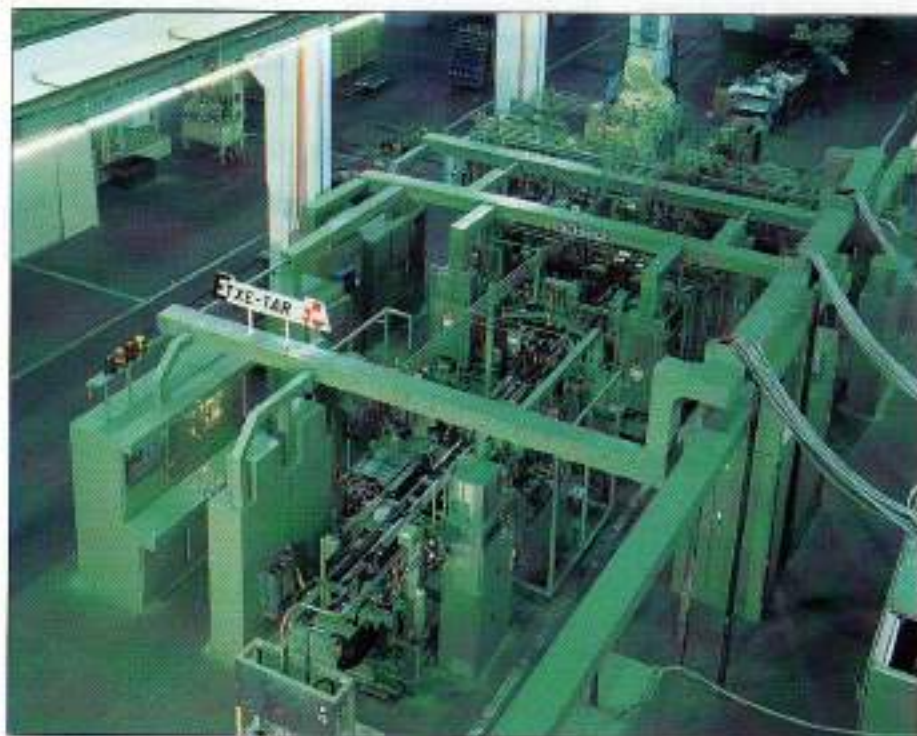
Una máquina transfer de las fabricadas en las instalaciones de Etxe-Tar en Elgoibar.
