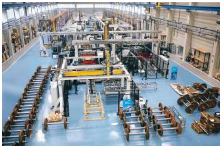
Línea de fabricación llave en mano para ejes montados de ferrocarril.
