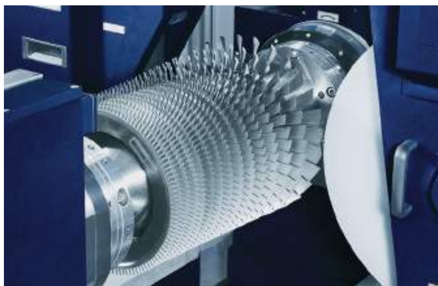
Rectificado de álabes del rotor de una turbina de avión.
