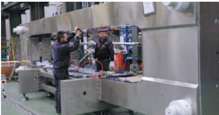
Fabricación y montaje de equipos HPP en la planta de Burgos.
