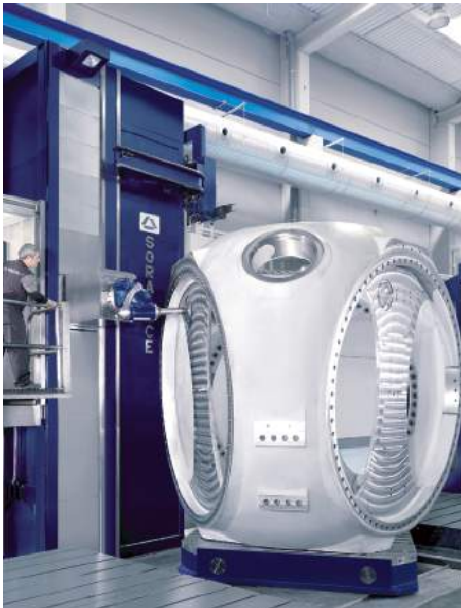
Fresado del buje del molino eólico.
