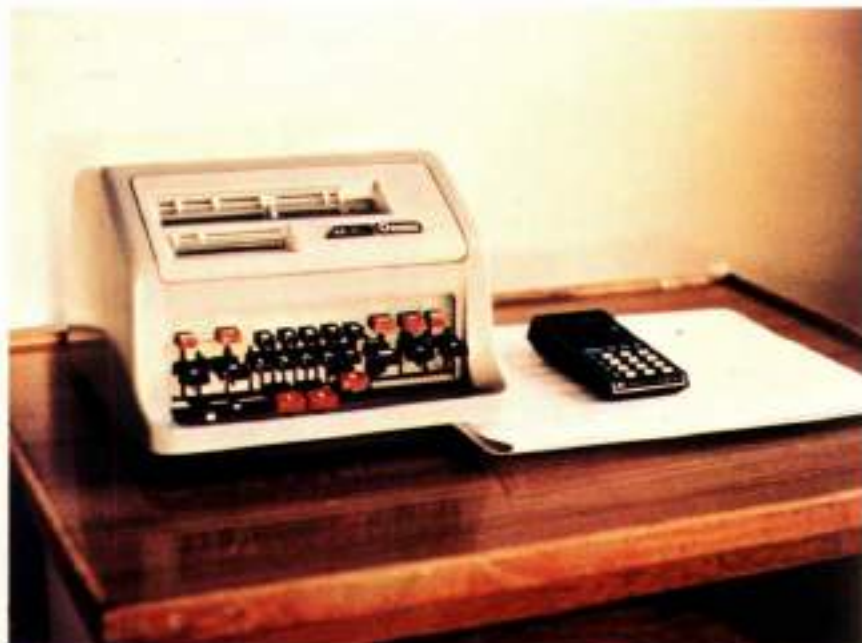
La máquina de calcular mecánica mantuvo su estructura con ligeros cambios durante casi dos siglos. La electrónica inició una profunda transformación y la microelectrónica la aceleró. Es un buen ejemplo de un producto clásico totalmente mecánico que pasa a ser totalmente electrónico.
