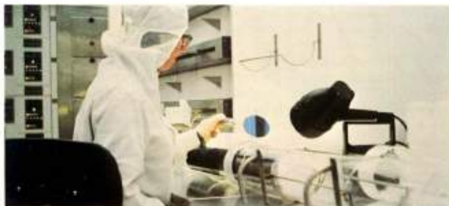
La primera operación es obtener una oblea de silicio pulida a espejo para iniciar los sucesivos procesos de fotolitografía y difusión.
