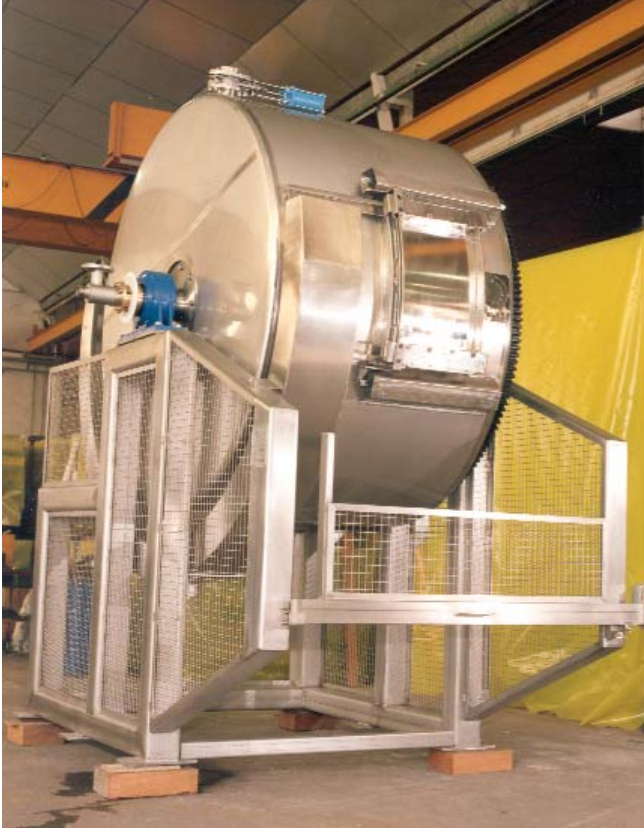
Máquina para procesado de cuero. (Sistema de "Cangilones")
