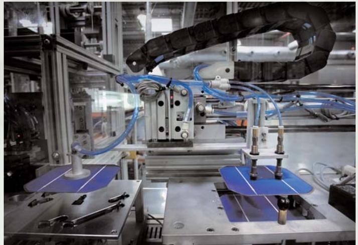
Detalle de la máquina de soldadura de ristra
