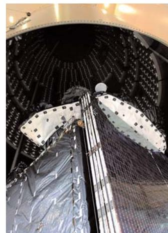
El satélite Spainsat en el momento de ser "encapsulado" en la parte superior del lanzador Ariane (Foto ESA)
