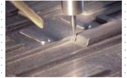
Mecanizado de radios de molde de inyección (herramienta de 0,8 mm de diámetro)
