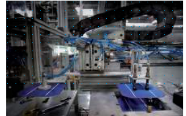
Detalle de la máquina de soldadura de ristra
