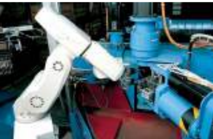
Detalle de rectificado robotizado
