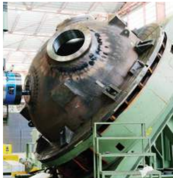
Mecanizado final en un fondo de generador de vapor
