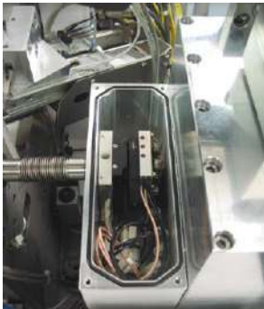
ALBA - Piezo electric shutter @GLS
