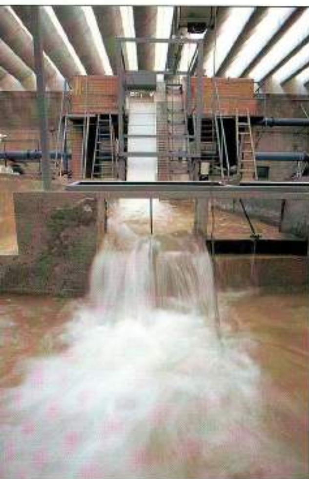
Dos vistas del ensayo realizado en modelo reducido de aliviadero escalonado para presas.
