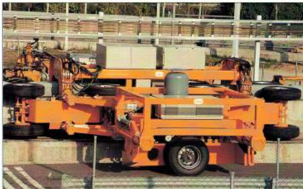
Vehículo simulador utilizado en la pista de ensayo de firmes a escala real.
