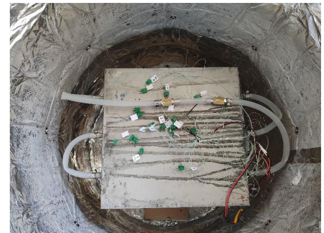
Interior cámara térmica y vacío
