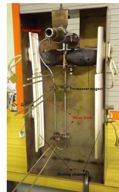
Resistímetro instalado en LIFUS6 (ENEA)
