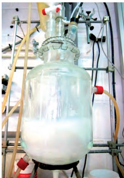
Reactor para fabricación de dispersiones
