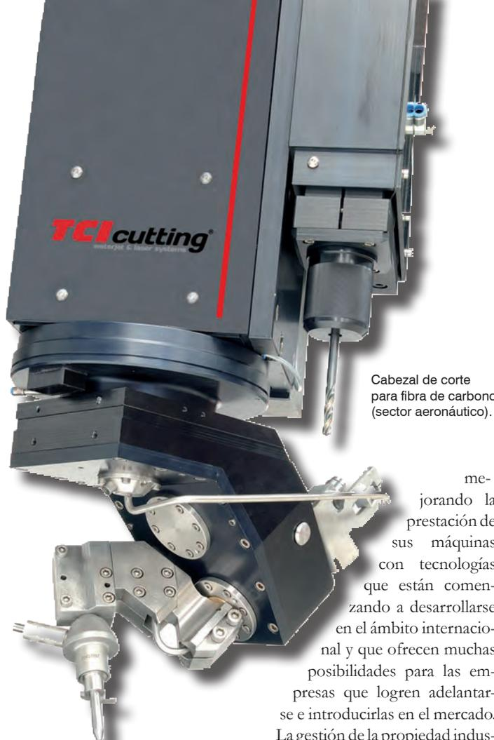
Cabezal de corte para fibra de carbono (sector aeronáutico).
