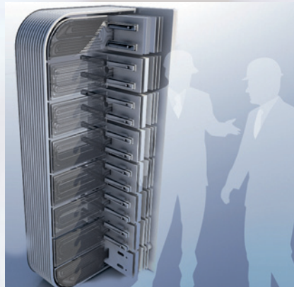
Test Blanket Module
